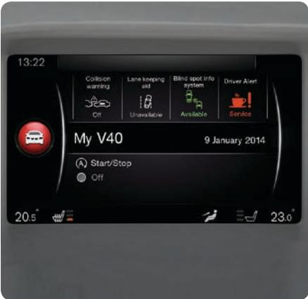
Dans le système MY CAR, de nombreuses fonctions de la voiture sont traitées, comme par exemple paramètres de l'horloge, des rétroviseurs extérieurs et des serrures. Voir la rubrique précédente "Comment naviguer dans le système Infotainment ?" pour mieux connaître les fonctions de chaque touche.
