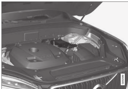
Apuakku sijaitsee laatikossa joustintukitornin vieressä.
