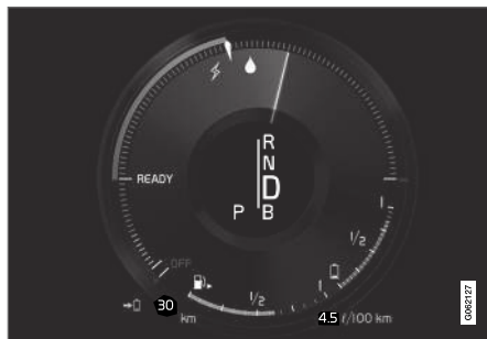
Førerdisplayet ved fremdrift med både el- og forbrændingsmotor.
