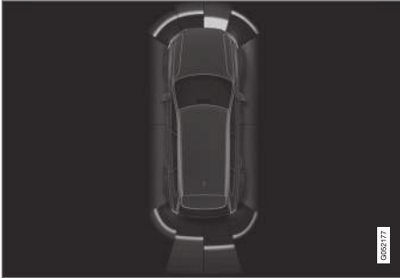
Skærmvisning med forhindringszoner og sensorsektorer.
