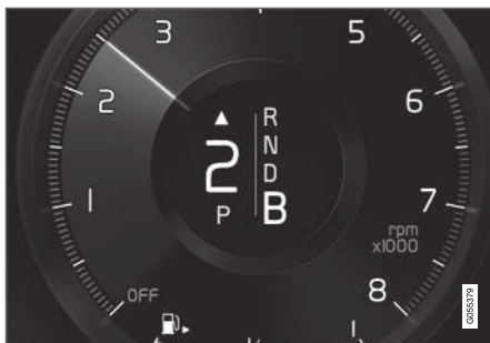
Gearskiftindikator på førerdisplayet 5 .
