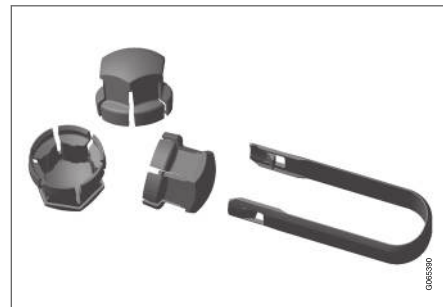
Værktøj til at fjerne hjulboltenes plastkapsler.
