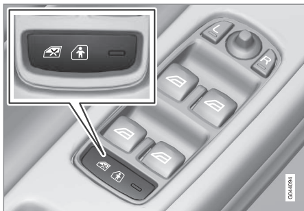
Pannello di comando nella portiera del conducente.
