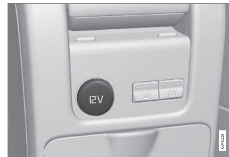
Preso da 12 V nel tunnel, sedile posteriore.
