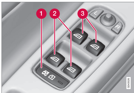
Pannello di comando nella portiera del conducente.
